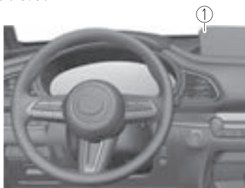
1. Caméra de surveillance du conducteur
