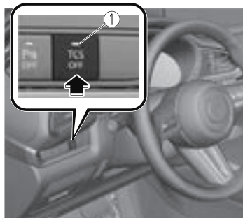
1. Témoin de l'interrupteur TCS OFF
